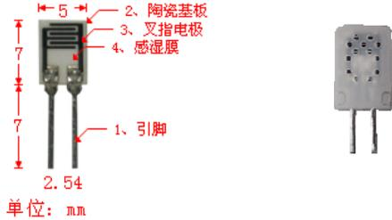
附图 (一) 外形尺寸图:  $7.5 \times 4 \times 11\text{mm}$  引脚间距:  $2.54\text{mm}$
