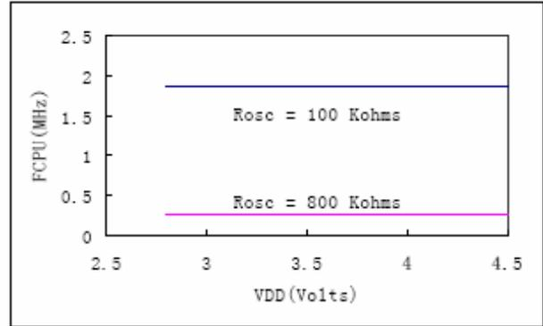
$V_{DD} = 4.5V, T_A = 28^\circ C$
