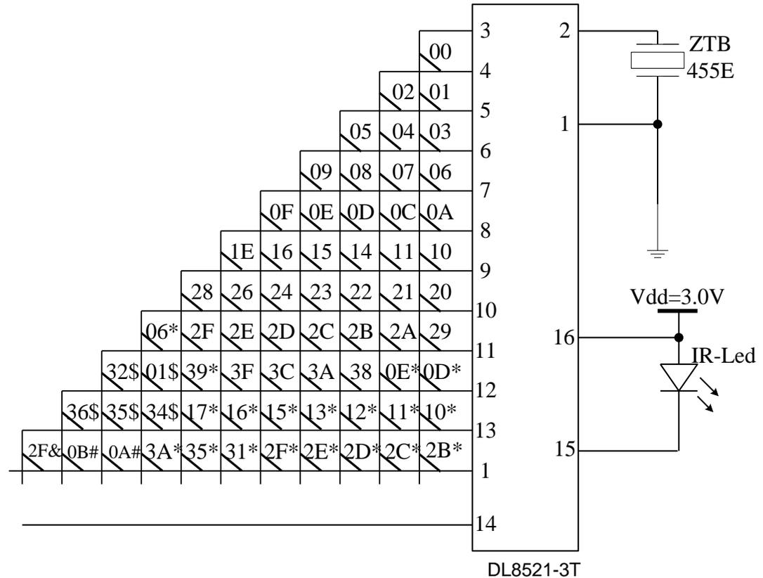
注：芯片内部已设置电源滤波电路，外围可以无须再加。
