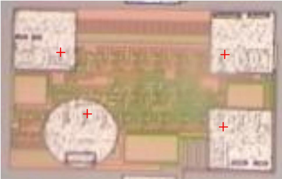
打线定位时，中心点一定要到压焊点往里四分之三的位置，如上图红色十字架位置所示，IC表面是有隔离层的，不用担心打线往里后会出现问题。
